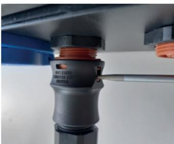
Die Entnahme ist werkzeuglos nicht möglich. Sie benötigen ein Lösewerkzeug, z.B. einen Schraubendreher. Drücken Sie mit dem Schraubendreher in die seitliche Öffnung des Steckers. Unter gleichzeitigem, leichtem Zug am Steckergehäuse lässt sich dieser nun lösen. Nach korrektem Herausziehen des Steckers verbleibt der schwarze Verriegelungsstift im Buchsengehäuse der ONgineer Ladestation und sorgt bei Wiedereinstecken des Steckers für erneute Verriegelung.
